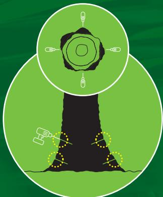
Use una broca de 6mm con una profundidad de perforación que no exceda 1/3 del diámetro del tronco.
